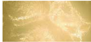
一般微弾性フィラー(なみがた) + 一般水性外装用塗料(つや有り)
